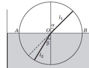
Птолемей погружал этот круг в воду до диаметра  $AB$  и, поворачивая нижнюю линейку, добивался того, чтобы линейки лежали для глаза на одной прямой (если смотреть вдоль верхней линейки). После этого он вынимал круг из воды и сравнивал углы падения  $\alpha$  и преломления  $\beta$ . Он измерял углы с точностью до  $0,5^\circ$ . Числа, полученные Птолемеем, представлены в таблице.
