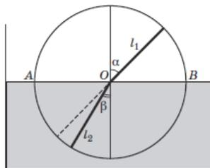
Птолемей погружал этот круг в воду до диаметра  $AB$  и, поворачивая нижнюю линейку, добивался того, чтобы линейки лежали для глаза на одной прямой (если смотреть вдоль верхней линейки). После этого он вынимал круг из воды и сравнивал углы падения  $\alpha$  и преломления  $\beta$ . Он измерял углы с точностью до  $0,5^\circ$ . Числа, полученные Птолемеем, представлены в таблице.
